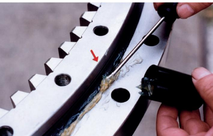
Bild 17: Fettentnahme an der Dichtlippe
