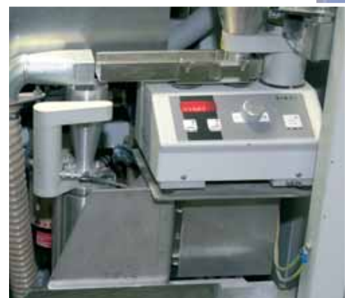
Granulómetro Laser integrado para analizar las finuras de las muestras de cemento y de harina de crudo.
