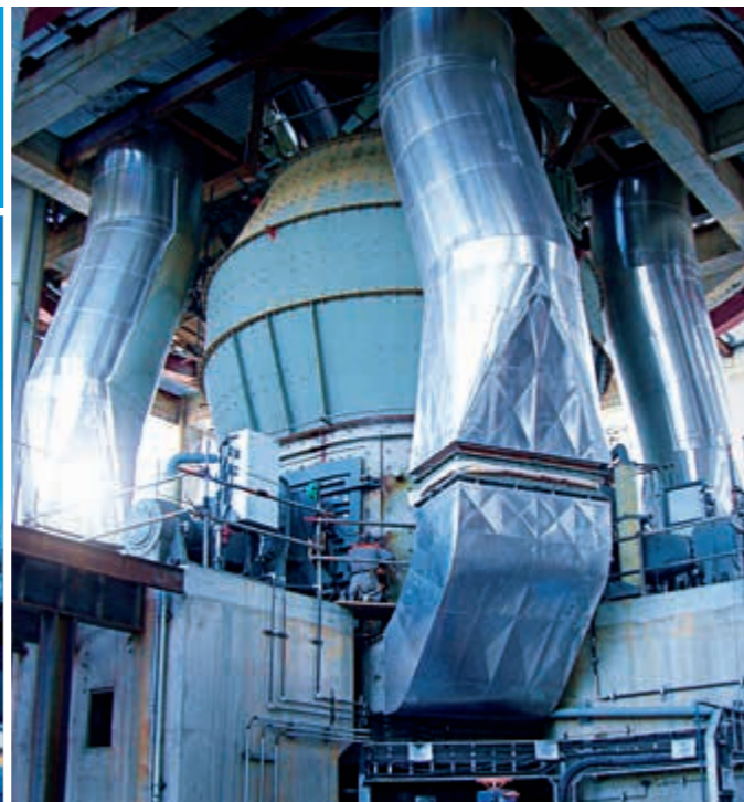
QMR 2 43/21 en Brasil: Alcanza finuras de un 8% R 90 µm.
