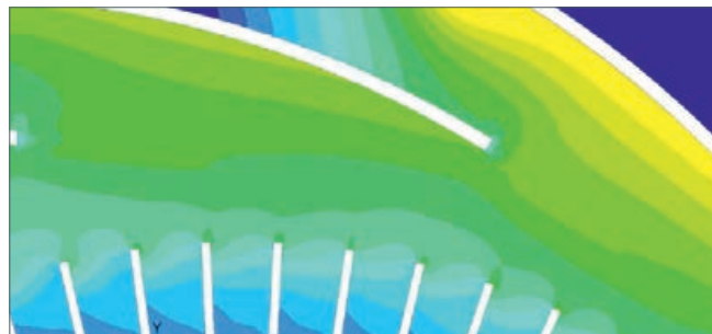
Optimale Luftverteilung durch gebogene Leitschaufeln
