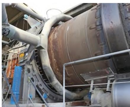
Graphitblockdichtung am Drehofen an der Auslaufseite.
