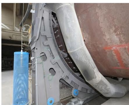
Zwei individuelle Spannseile für Obertrum und Untertrum sorgen für eine einfache und gleichmäßige Vorspannung durch Stahlgewichte.
