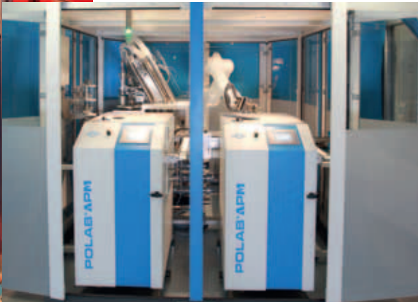
POLAB® AMT avec deux modules de préparation d'échantillons POLAB® APMplus.
