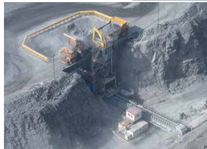
Oben: zwei Vorbrechanlagen für Eisenerz und Abraum mit Kreiselbrechern KB 63-75. Die Brecher werden von zwei Seiten direkt mit Muldenkippern beschickt.
