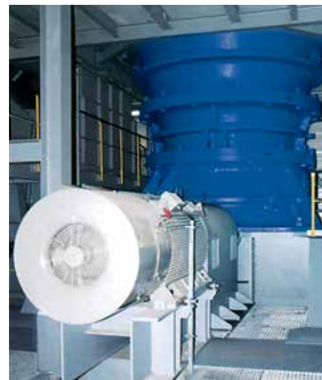
Kreiselbrecher mit Stahllamellenkupplung, Zwischenwelle und Sicherheitskupplung
