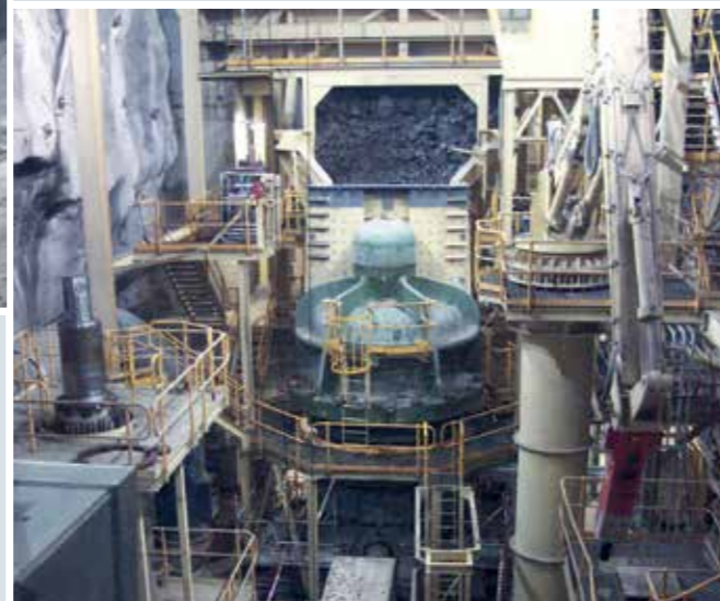
Unten: Backenkreiselbrecher BK 63-75 in einer Kupfererz-Brechanlage Untertage Durchsatz 2.000 t/h Produkt P80 ≤ 150 mm Aufgabe im Block caving max. 2.000 x 1.500 x 1.000 mm
