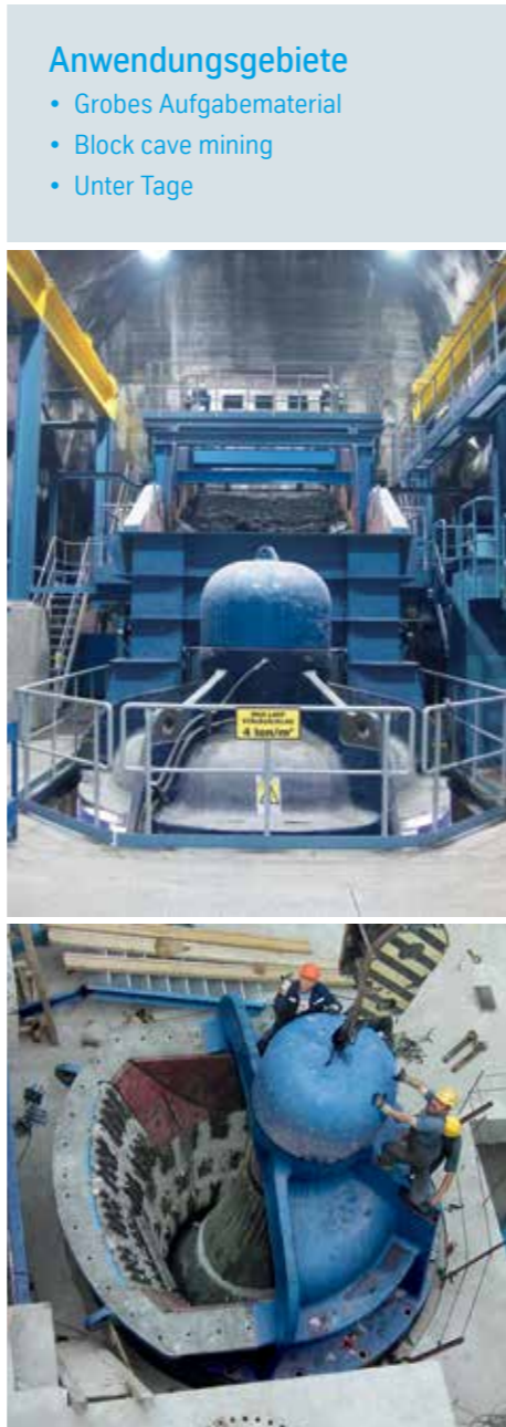
Backenkreiselbrecher für Eisenerzgewinnung unter Tage und das Brechmaul eines BK 63-75 in einer stationären Kupfererzanlage
