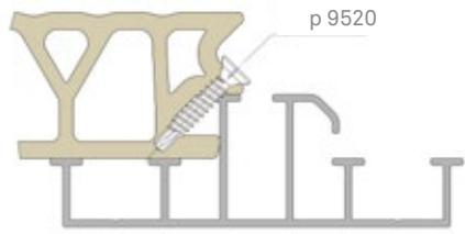
Vorbohrung 3 mm
