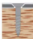
Senkkopf mit Deckblech, eingezogen
