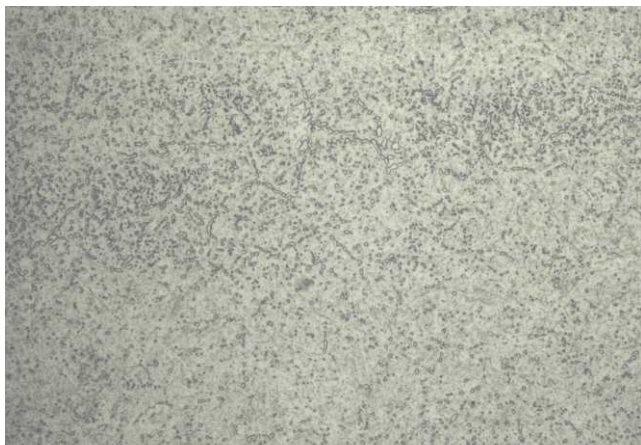
THYROPLAST-2083 ESU SUPRA Inhomogene, ungleichmässige Karbidverteilung
